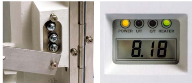
Potentiometer für Kalibrierung Display
