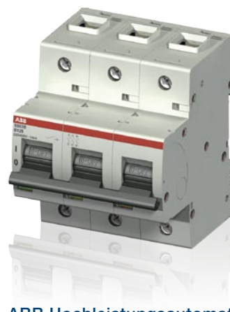
ABB Hochleistungsautomaten S800B - Die kostengünstige Alternative für Kurzschlüsse bis 16 kA - Bemessungsstrombereich: 32–125 A
