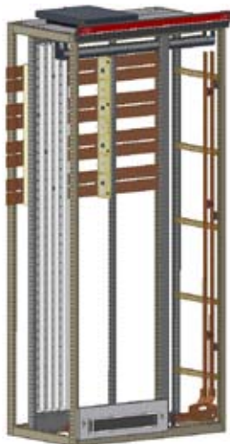
MNS karkass ar vara galvenajām kopnēm un L-veida sadales kopnēm ar sudraba pārklājumu izvelkamo moduļu uzstādīšanai.
