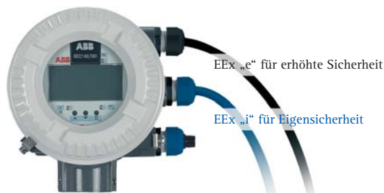
Bild 3. Der Masse-Durchflussmesser CoriolisMaster vereint die beiden Anschlussmöglichkeiten „eigensicher“ und „erhöhte Sicherheit“ in einem Gerät
