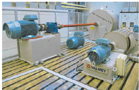
Versuchsaufbau mit dem Direktantriebssystem im Forschungs- und Entwicklungszentrum von ABB in Helsinki.
