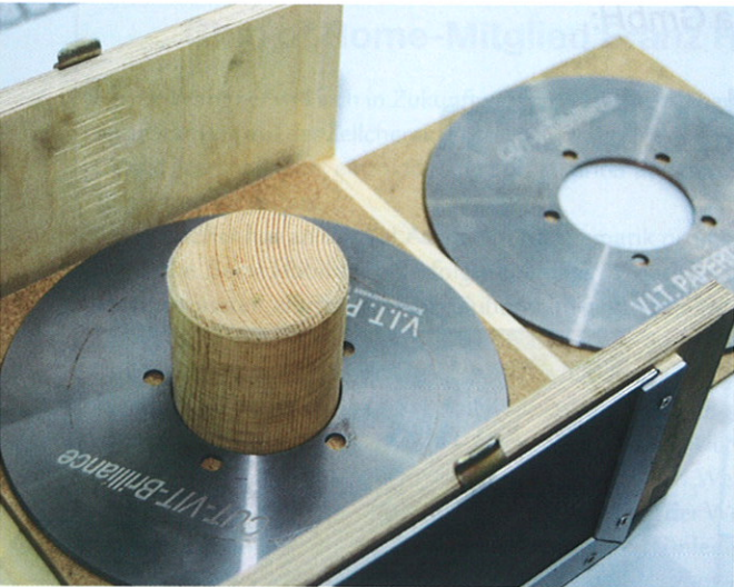
Komfortables Messertablett: Damit lassen sich die Messer sicher zur Maschine transportieren und Verletzungsgefahren beim Gebrauch spürbar minimieren. Fotos (3): Frank Baier
