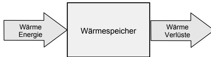
Bild 5: Ein thermisches Einkörpermodell mit Verlusten
