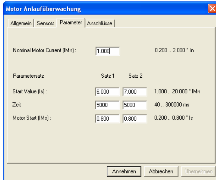
Bild 2: Einstellparameter für die Anlaufüberwachung
