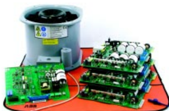
预防性维护套件是经由选择的对 SAMI STAR 进行选定的预防性维护服务所需的必要部件
