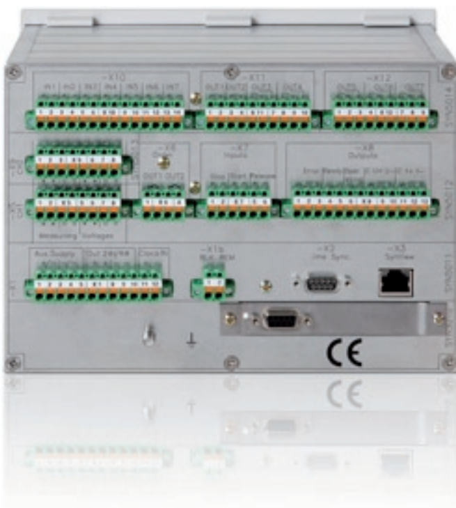
Fig. 10: Todas las conexiones convencionales se hacen por medio de regletas de contactos enchufables. Éstos son en gran parte superfluos donde se utiliza la interfaz de comunicación: las señales se pasan vía el enchufe Sub-D de 9 polos en el lado inferior izquierdo. La conexión a Ethernet para el mantenimiento remoto se hace vía el terminal RJ45.
