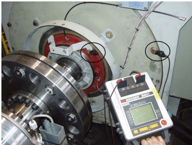
Figur 7-4 Mätning av isolationsresistansen för ett rullager
