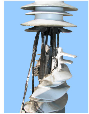
Рисунок 4. Неудачное испытание короткого замыкания ограничителя без обмотки.
