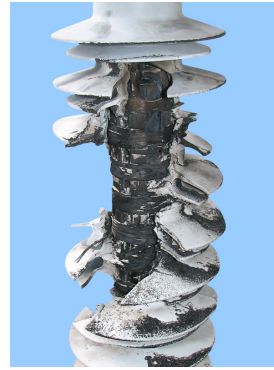
Рисунок 3. Успешное испытание короткого замыкания ограничителя перенапряжения PEXLIM с обмоткой.
