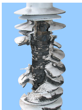
Figura 3. Prueba en cortocircuito exitosa del descargador de sobretensiones PEXLIM con arrollado de correa.
