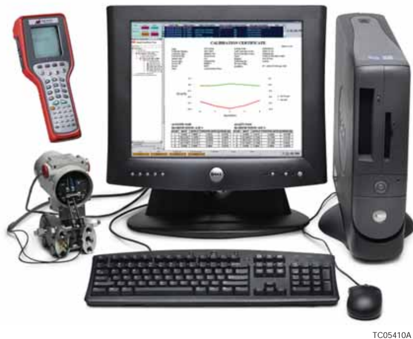
Bild 10. Meriam Communicators/PC mit den Field Device Management Tools in System 800xA
