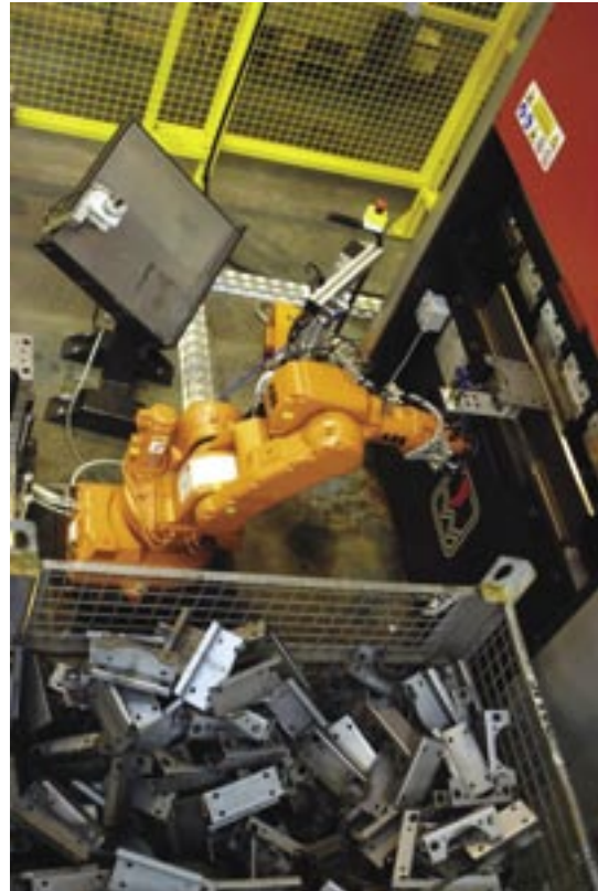
Biegen von Blechen bei Visentin im Werk Preganziol
