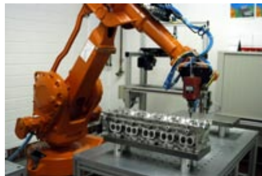
Rifilatura del cilindro sul blocco motore.
