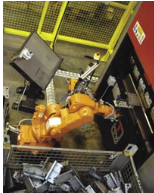
Doblado de chapa en la planta de Visentin en Preganziol.
