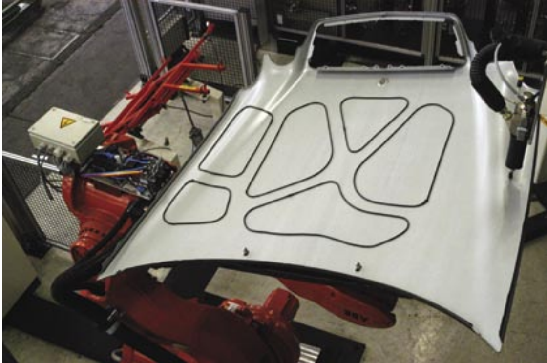
Roboter-gesteuerte Verklebung einer Motorhaube bei einem Mercedes CLKC208.
