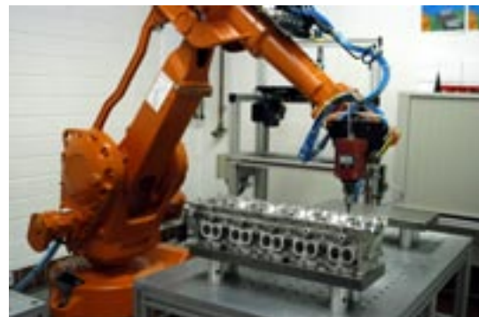
Entgraten des Zylinders zum Motorblock
