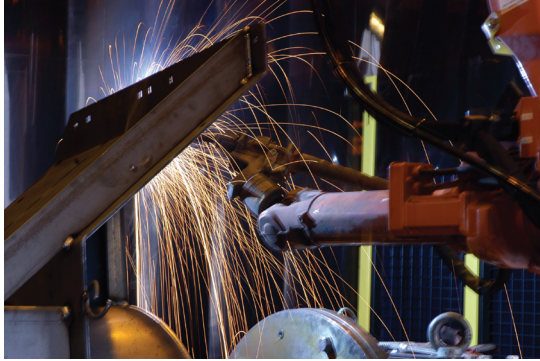
Ogni spazzaneve richiede oltre 300 saldature.
