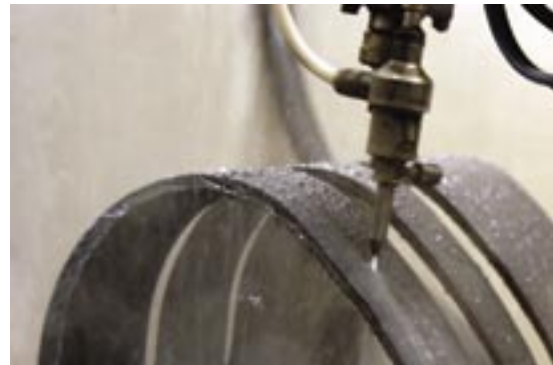
Corte del pie Flex-Foot por chorro de agua.
