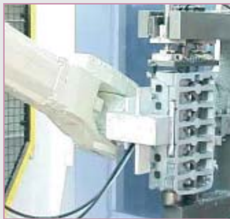
Roboterhandling Gussteil aufspannen auf LCC – Gussbearbeitungszelle Robot handling: clamping of casting on LCC casting cleaning cell
