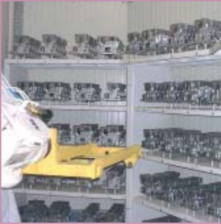
Roboterhandling, mit Gussteilbearbeitung Robot handling for casting processing
