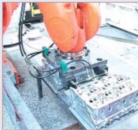
Roboterhandling Gussteil aufspannen auf LCC – Gussbearbeitungszelle Robot handling: clamping of casting on LCC casting cleaning cell
