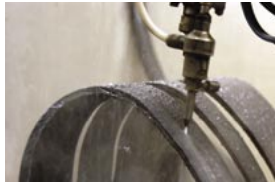
Découpe du Flex Foot au jet d'eau.
